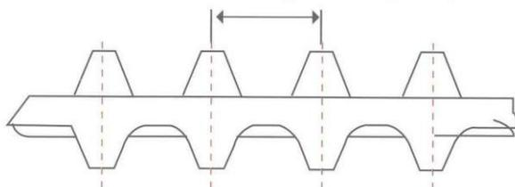
B) Misura la distanza del passo fra un dente e l'altro del tuo cingolo:
